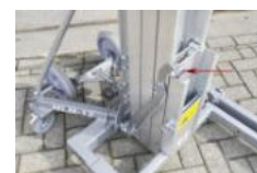
Système de blocage pour le transport
